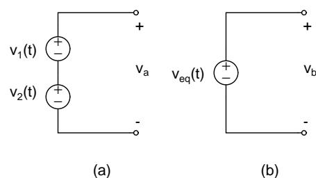
$$v_1 + v_2 - v_a = 0 \Rightarrow v_a = v_1 + v_2$$
